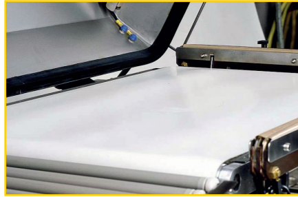
EVA-9-11. Regulación de la altura de la cinta transportadora (opción motorizada en línea automática).
