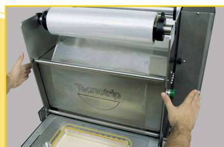
Accionamiento de doble pulsación para entrada automática del cajón. La salida es automática al finalizar el ciclo (conveniente para el envasado de productos frescos).
