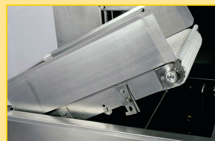
RET-A-4 / RET-A-4-11. Elevación de la cinta transportadora para facilitar la limpieza del interior del tanque.
