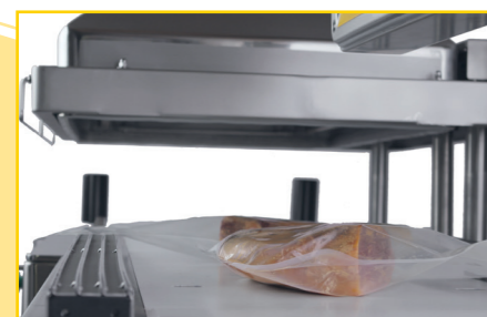
Fácil manipulación del producto a envasar; sin obstáculos entre la cinta prealimentadora y la cámara de vacío.
